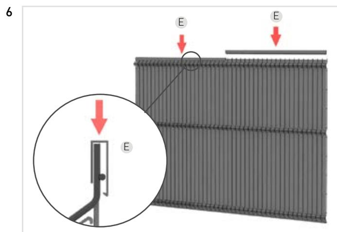
¿Sabías que el kit Rewood también puede instalarse trenzando las láminas verticales? Con o sin las láminas de pliegue. Es una cuestión de estética, de tiempo invertido en la instalación, pero también se trata de un pequeño truco para sujetar mejor las láminas en los paneles de altura 1,20m.
