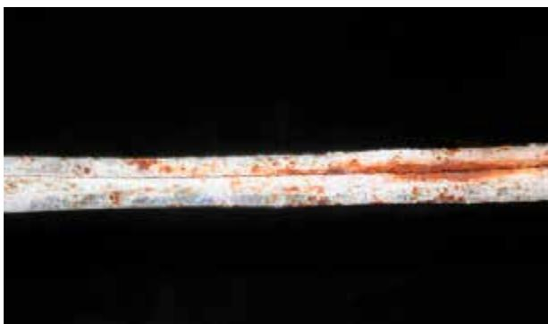
**Recubrimiento: Galvanizado Reforzado 230g/m<sup>2</sup>**
